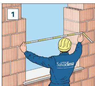
1. Misurare il foro grezzo ricavato sulla muratura e verificare se esso è compatibile con le misure indicate nella scheda tecnica forometrica e/o con le dimensioni del prodotto da posare.
