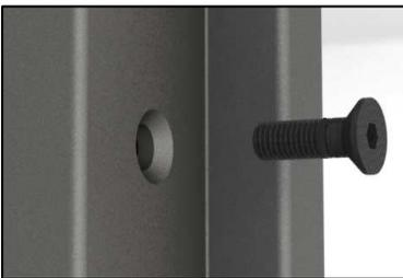
Infilare le viti TPS M8x25 fornite a corredo senza serrarle. Piombare il telaio, serrare le viti TPS M8 alla coppia di **11 Nm** . se presente la battuta inferiore in alluminio, applicare una congrua riga di silicone sulla superficie inferiore, in modo da garantirne l'ermeticità, siliconare poi i bordi del telaio alla muratura. Guarnizioni 1 e 2 non presenti nella linea porte Smart.
